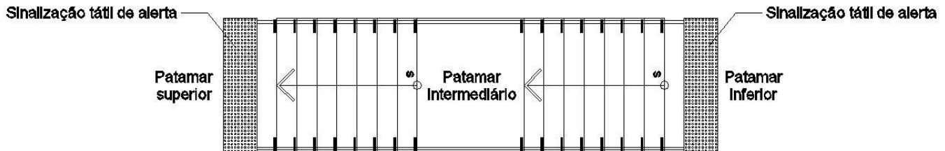
Figura 17 – Patamares de escadas e rampas contínuas
